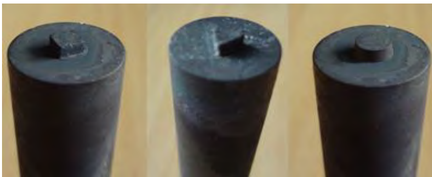
شکل ۳. پین ابزار جوشکاری با هندسه مختلف مورد استفاده در این تحقیق
